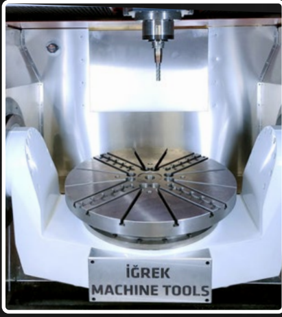
DÖNER TABLA Ø800 mm 450 RPM ROTO - TILTING TABLE
